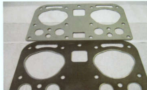
De koppakking en zijn 'vezel' dichtingslaag.
