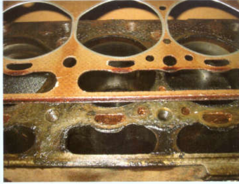
De meest versterkte kant moet altijd aan de cilinderblokzijde.
