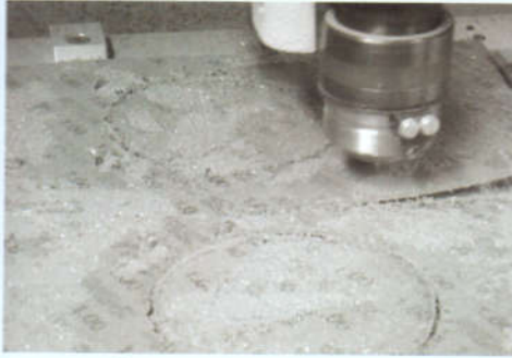
... waarna de computer gestuurde bank hem uit snijdt in het basismateriaal.
