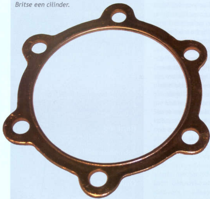
Uit de oude doos: een geheel koperen koppakking voor een Britse een cilinder.
