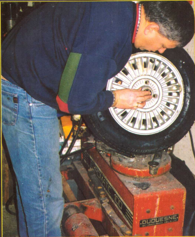
Kees Jongejan van Classic Tire aan het werk. Op deze machine wordt de band van of op de velg geperst.
