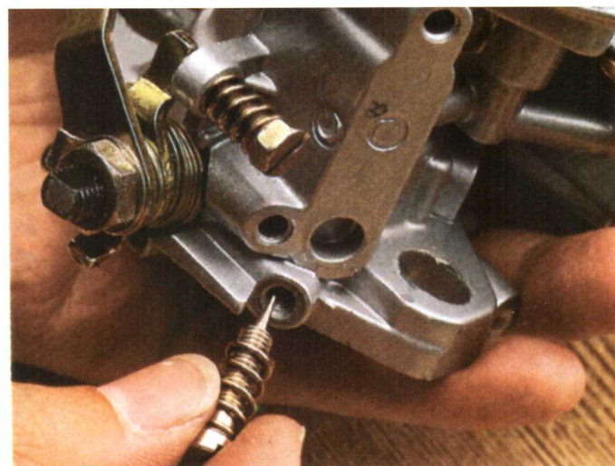
Fig. 30 Stelschroef stationair mengsel aanbrengen
