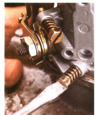
Fig. 37 Stationair mengsel afstellen
