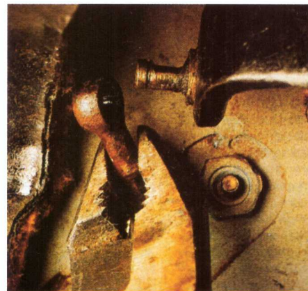
8. Met tang kabeloog op pedaalpen schuiven
