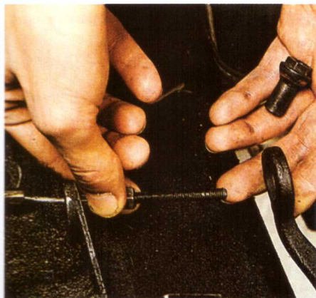
5. Kabel losmaken van koppelingsvork
